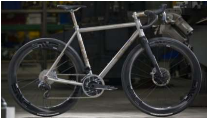
MOOTS VAMOOTS RCS CARRETERA CUALQUER SUPERFICIE Ruedas: 700c, hasta 32mm Cuadro Titanio, tubería conificada RSL Horquilla Carbono Tallas: 48, 50, 52, 54, 55, 56, 58, 60, 62
