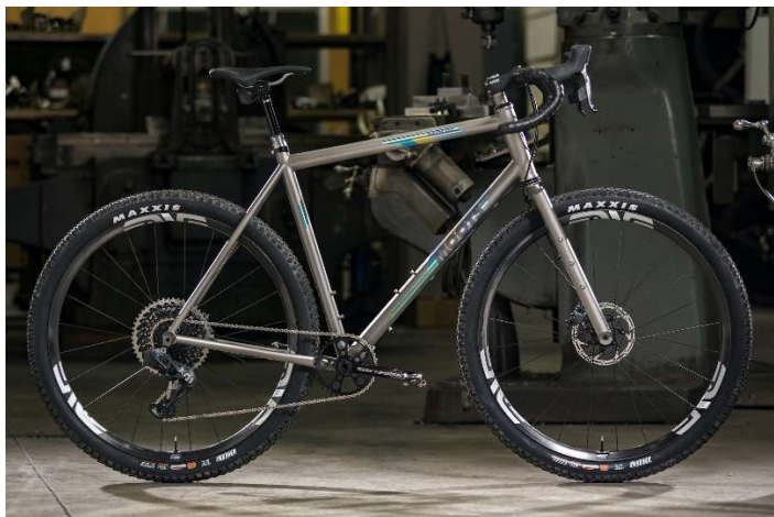
MOOTS ROUTT 45 GRAVEL Ruedas: 700c, hasta 50mm Cuadro Titanio Horquilla Carbono Tallas: 50, 52, 54, 55, 56, 58, 60
