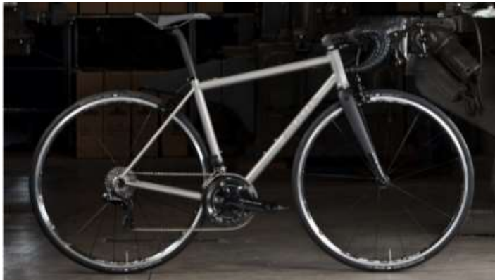
MOOTS VAMOOTS RSL CARRETERA Ruedas: 700c Cuadro Titanio, tubería conificada RSL Horquilla Carbono Tallas: 48, 50, 52, 54, 55, 56, 58, 60, 62
